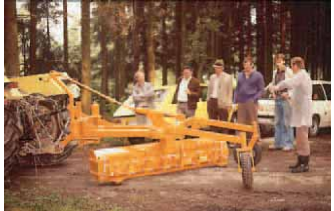
Vorführung eines Planierschildes zum Wegebau und Wegeunterhalt, 1987.
