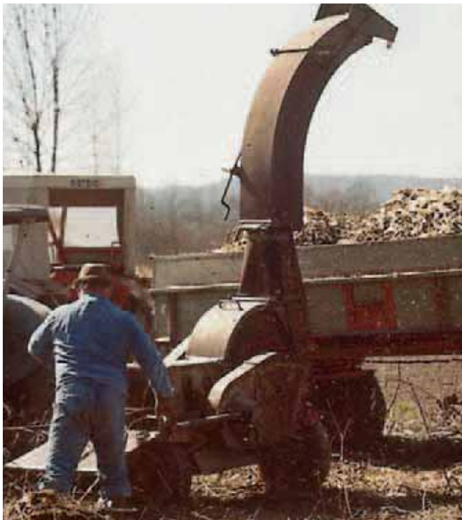
Holzhäcksler der ersten Generation – oft auch als Reisighackmaschine oder Buschhacker bezeichnet. Mittlerweile sind kranbeschickte Holzhäcksler, teilweise mit eigenem Motor und mit wesentlich größerer Leistung, Standard.
