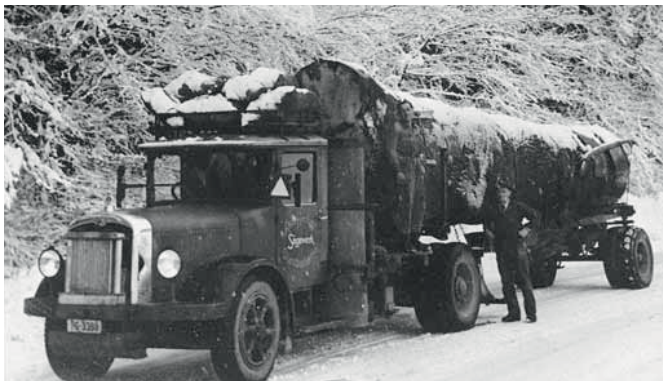
Mangels anderer Treibstoffe wurden Fahrzeuge mit Holzvergäsern betrieben – bei diesem Holzlastwagen hinter dem Führerhaus zu sehen.
