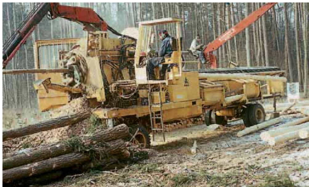
Entrindungsmaschine für Stammholz für den Waldeinsatz der Forstmesse Porrau. Entrindet wird heute nur noch im Sägewerk.
