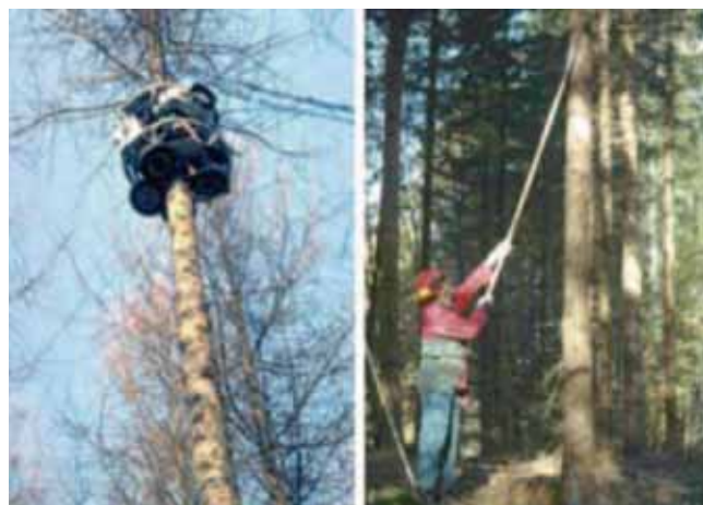
Links: Klettersäge in Aktion (Foto K. Häne, WSL) und rechts: Wertastung mit der Stangensäge (Foto LWF)
