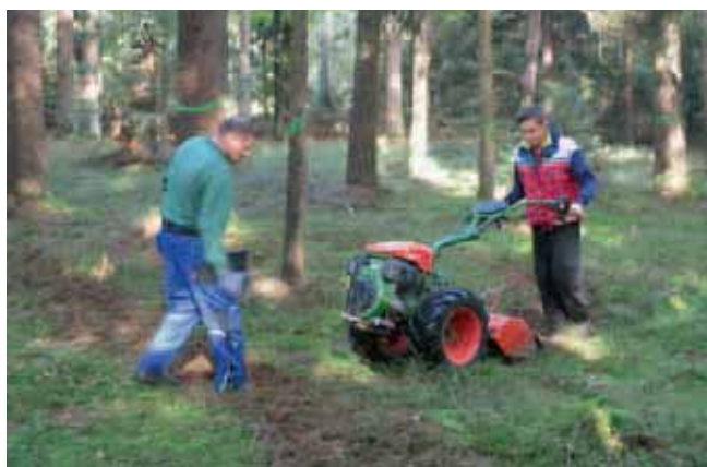
Kleine Gartenfräse beim Einfräsen der Eicheln – mit freundlicher Genehmigung des Krieger Motorsägenhandels Landau
