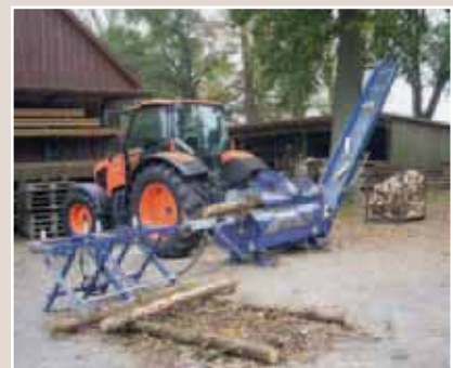
Brennholzautomat: Vom langen runden zum ofenfertigen Holz in einem Schritt
