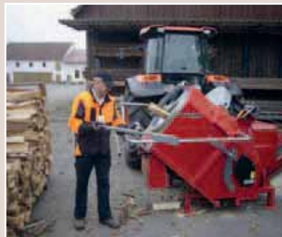
Trommelsäge: Gespaltene Meterstücke mit hoher Stundenleistung sicher ablängen – als Leihgerät verfügbar
